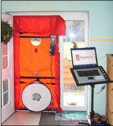
Bild 5-10 Blower-Door-Messung (hier an einer Haustür) (Quelle: www.bsm-strohmeier.de/html/blower-door-test.html )
