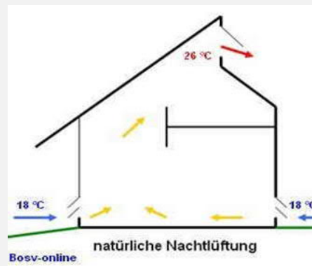
Natürliche und mechanische Nachtbelüftung (Abbildung: www.bosv-online.de )
